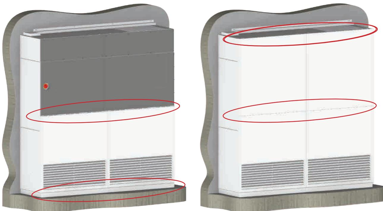
Die beiden unteren Verkleidungen an den Befestigungshaken am Gerät einfädeln (oben und unten).
